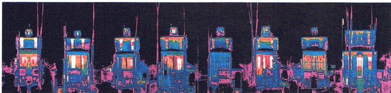
Rys. 19.20. Termogram uwidacznia za pomocą umownie przyjętych kolorów moc wypromieniowywaną przez domy stojące wzdłuż ulicy. Kolory: biały, czerwony, różowy, niebieski i czarny odpowiadają kolejno mocy promieniowania od wartości największej do najmniejszej. Na tej podstawie można stwierdzić, gdzie w ścianach domów umieszczono izolację, w których oknach wiszą grube zastony oraz w których domach na piętrze pod sufitem jest cieplejsze powietrze
