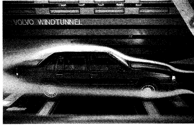
Rys. 15.13. Linie prądu w strumieniu powietrza opływającego samochód w tunelu aerodynamicznym, uwidocznione dzięki wprowadzeniu dymu do strumienia powietrza
