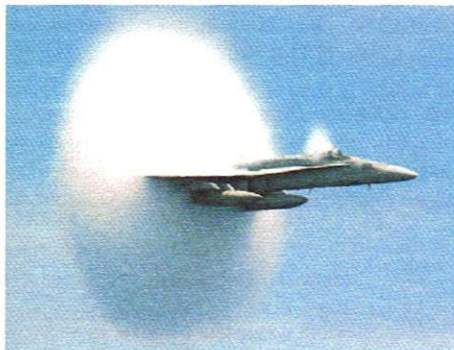
Rys. 18.22. Fala uderzeniowa wytwarzana przez skrzydła odrzutowca Navy FA 18. Jest ona widoczna, gdyż gwałtowny spadek ciśnienia powietrza w fali uderzeniowej powoduje kondensację cząsteczek wody w powietrzu i powstanie mgły
